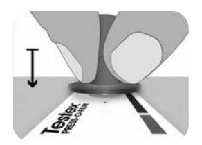
Para las superficies cóncavas: Voltear la herramienta de pulido de alta precisión y mantenerla inclinada. Utilizar la zona curva cerca del logotipo de Testex en la parte superior de la herramienta para pulir.
