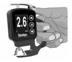
Una vez estabilizado el valor medido, el valor visualizado parpadea, y se guarda si el Modo Memoria está habilitado (pág. 6). NOTA: El medidor debe volver a -50 µm (-2,0 mils) después de remover la cinta de réplica. Si se visualiza un número diferente después de haber realizado una medición y haber quitado la cinta de réplica, debe limpiar los yunques como ya se ha descrito.
