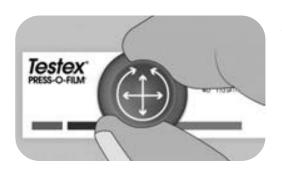
5.Utilizar la herramienta de pulido, alternando movimientos lineales (x-y) y circulares para pulir totalmente la espuma de réplica hasta obtener un aspecto gris punteado uniforme en toda la zona de medición.
