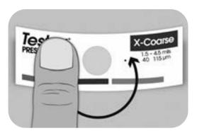
3.Aplicar la cinta de réplica sobre la superficie. Presionar el reverso adhesivo de la cinta alrededor de la espuma de réplica para asegurarse de que se mantiene en su posición durante el proceso de pulido.
